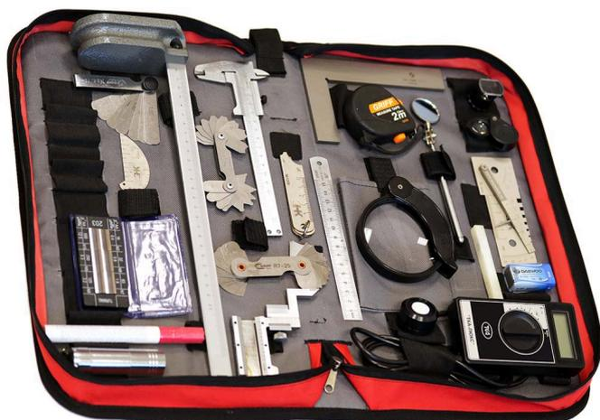
Визуально-измерительный комплект для неразрушающего контроля визуальным и измерительным методом. Комплект предназначен:
