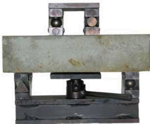
Оборудование для контроля бетона, раствора, кирпича - Устройство УРР.
