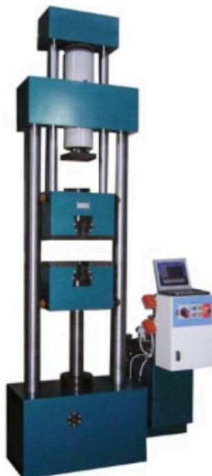
Автоматизированные разрывные машины Р-М-авто являются развитием выпускаемых ранее машин типа Р и предназначены для статических испытаний образцов металлов из листового и круглого проката, а также арматурной стали на растяжение при нормальной температуре по ГОСТ 1497, 12004, 6996, ASTM E8, EN 10002 и др. при нормальной температуре, а в комплекте с приспособлением на изгиб/сжатие - для испытаний на изгиб по ГОСТ 6996, 14019 и др., осадку по ГОСТ 8817, бортование по ГОСТ 8693 и др.
