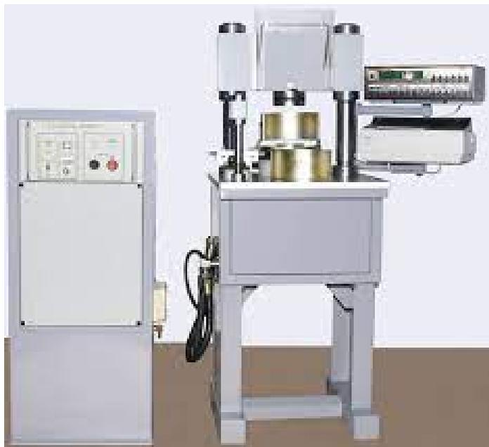
Машина для испытания на изгиб и сжатие образцов цемента.
