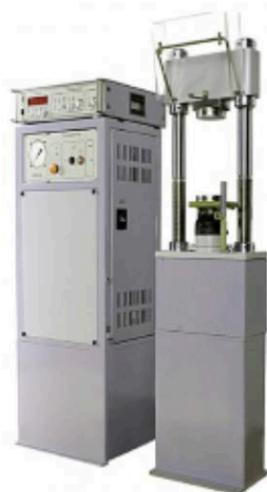
Гидравлическая испытательная машина ПС– это тот тип технических устройств, который относится к машинам, оснащенным электрогидравлическим приводом. Цель, которую помогают достигнуть гидравлические испытательные машины этой серии – улучшение мощностных показателей процесса испытания.
