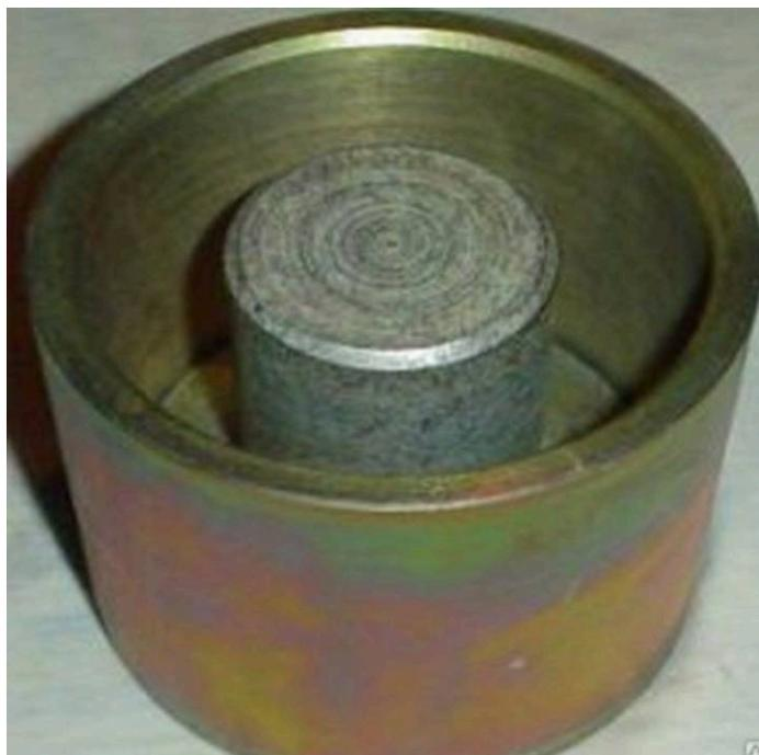
Цилиндр с плунжером ЦП предназначен для определения дробимости щебня по ГОСТ 8269-87.
