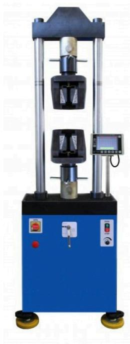
Испытательная разрывная машина типа РМГ-МГ предназначена для статических испытаний образцов металлов из листового и круглого проката и сварных соединений на растяжение и сжатие (изгиб) по ГОСТ 1497, ГОСТ 6996, ГОСТ 14019, ГОСТ 12004, ГОСТ 10922 при статических режимах нагружения.
