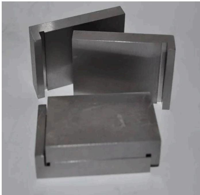
Нажимные пластинки типа ПЛБ предназначены для передачи нагрузки на половинки образцов-балочек согласно ГОСТ 310.4.
