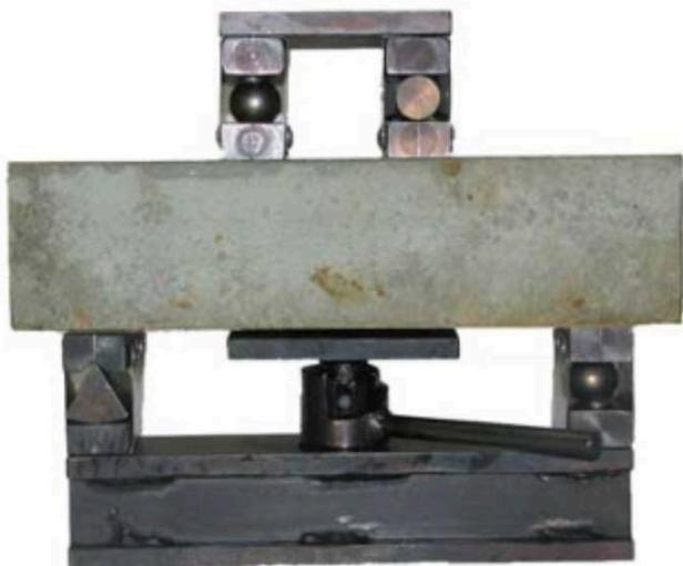
Устройство для испытания на растяжение при изгибе УРИ предназначено для реализации на прессе испытания на растяжение при изгибе образцов – призм размером 100x100x400 мм по ГОСТ 10180-90.
