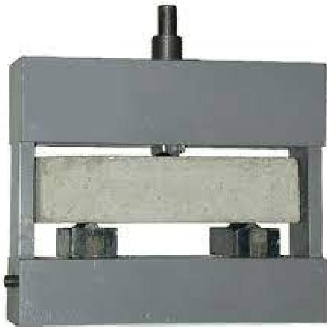
Нагружение на изгиб на практике случается чаще всего. Поэтому оно имеет большое значение для испытаний самых разных материалов. По этой причине испытание на изгиб предназначено для определения механических свойств стали, пластмасс, древесины, бумаги, керамики и других материалов.
