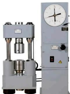
Разрывные малогабаритные машины РМ предназначены для статических испытаний образцов сварных соединений толщиной от 2 до 25 мм (типов XII, XIII, XV, XXVI, XXVII, XXVIII) на растяжение и изгиб по ГОСТ 6996-66.
