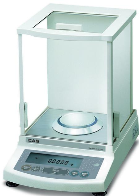
Лабораторные аналитические весы предназначены для статических измерений массы различных веществ и материалов. Весы этих серий относятся к специальному классу точности и обеспечивают наиболее высокую среди лабораторных весов точность измерений.
