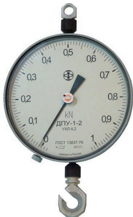
Это простое в использовании и надежное механическое измерительное оборудование, давно и хорошо себя зарекомендовавшее в работе. Данные динамометры предназначены для измерения статических растягивающих усилий.
