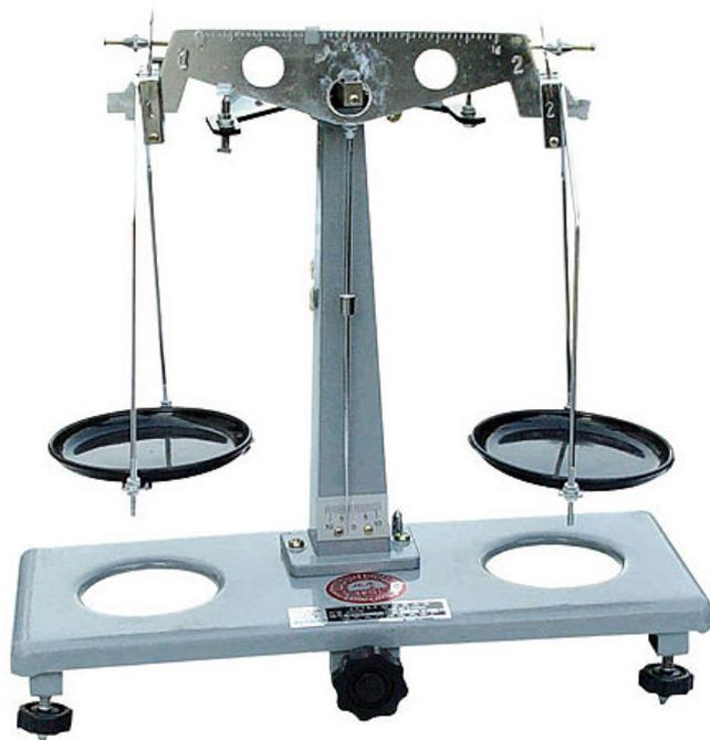
Весы технические равноплечие ВА-4М
