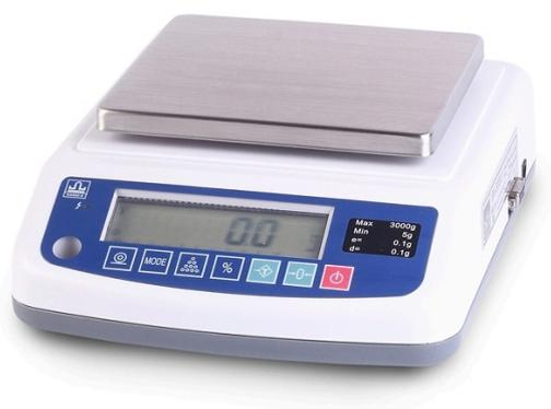
Весы лабораторные ВМК 4001 предназначены для взвешивания образцов массой до 4000 г и дискретностью 0,1 г.
