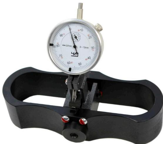
Динамометры эталонные переносные ДОСМ предназначены для поверки рабочих средств измерений статических сжимающих усилий.
