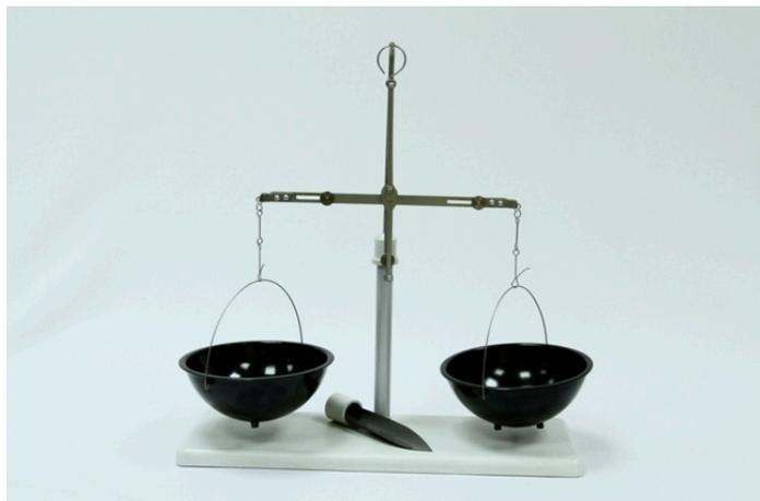
Весы лабораторные механические равноплечие предназначены для взвешивания в аптеках , в лабораториях навесок химических реоантов, медицинских препаратов. Весы предназначены для эксплуатации при температуре от +10 до +35°С
