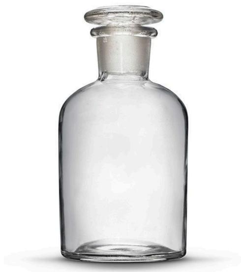
Светлая, с широким горлом склянка для реактивов предназначена для хранения различных химических веществ. Флакон можно герметично закрыть с помощью притертой стеклянной пробки.
