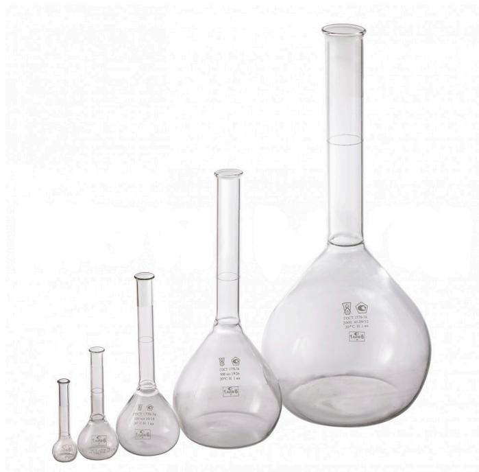
Применяется для измерения и хранения определенного объема жидкости.
