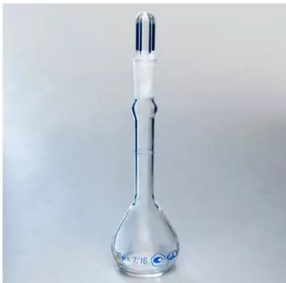
Пикнометр предназначен для определения плотности жидких веществ. Относится к точным измерительным приборам.
