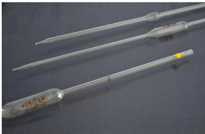
Применяется для точного отмеривания заданного объема жидкости.
