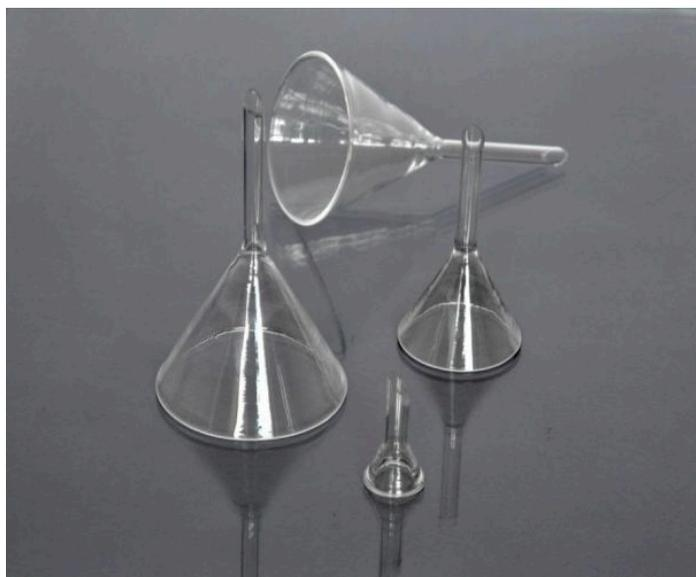
Воронка лабораторная В применяется для переливания жидкостей и фильтрования с помощью бумажного фильтра.
