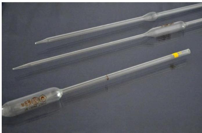
Применяется для точного отмеривания заданного объема жидкости.
