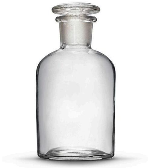
Светлая, с широким горлом склянка для реактивов предназначена для хранения различных химических веществ. Флакон можно герметично закрыть с помощью притертой стеклянной пробки.
