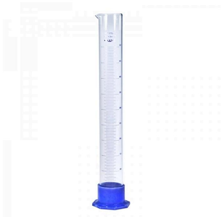
Мерные цилиндры с носиком используют для отмеривания нелетучих жидкостей.
