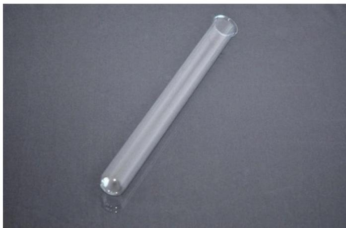
Пробирки предназначены для проведения различных работ. Выполнены из термостойкого стекла, без пробки.
