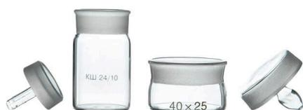
Стаканчик высокий для взвешивания СВ имеет шлиф и притертую крышку, что позволяет его использовать для хранения и взвешивания препаратов и веществ во время проведения лабораторных работ.
