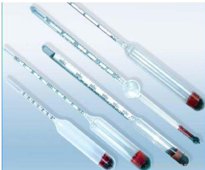
Этот прибор для оперативного определения плотности жидкости в диапазоне от 700 до 1800 кг/м<sup>3</sup>.
