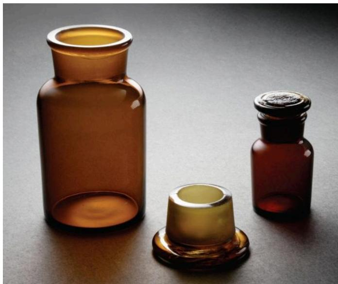
Темная, с широким горлом склянка для реактивов предназначена для хранения различных химических веществ. Флакон можно герметично закрыть с помощью притертой стеклянной пробки.
