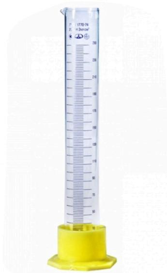
Применяются для облегчения измерения плотности с помощью ареометров.
