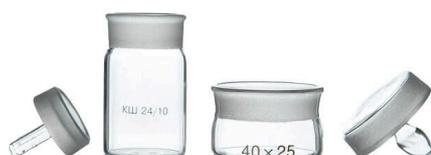
Стаканчик СН для взвешивания низкий (бюкс низкий) представляет собой тонкостенную стеклянную емкость со стеклянной крышкой, предназначен для взвешивания и хранения веществ, препаратов при лабораторных работах. Изготовлен из химико-лабораторного стекла по ГОСТ 21400-75. ТУ 4320-012-29508133-2009.
