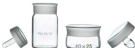
Стаканчик высокий для взвешивания СВ имеет шлиф и притертую крышку, что позволяет его использовать для хранения и взвешивания препаратов и веществ во время проведения лабораторных работ.
