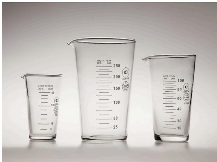
Мензурка стеклянная представляет собой сосуд из стекла с плоским дном в форме усеченного конуса, слегка расширяющегося кверху. Горловина снабжена носиком. Мензурка выполнена из стекла по ГОСТ 1770-74 с низким коэффициентом расширения. Мензурки применяют для приготовления растворов, для фильтрации и отстаивания жидкостей, для бытовых целей, для временного хранения, для переливания, пересыпания веществ.
