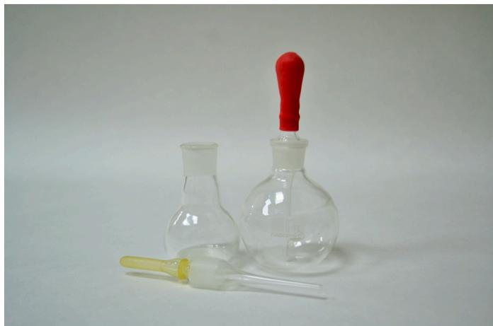
Капельница с притертой пробкой-пипеткой 2-50 мл предназначена для капельного дозирования невязких фотоустойчивых жидкостей. Изготовлена из стекла группы ХС1 по ГОСТ 21400-75.
