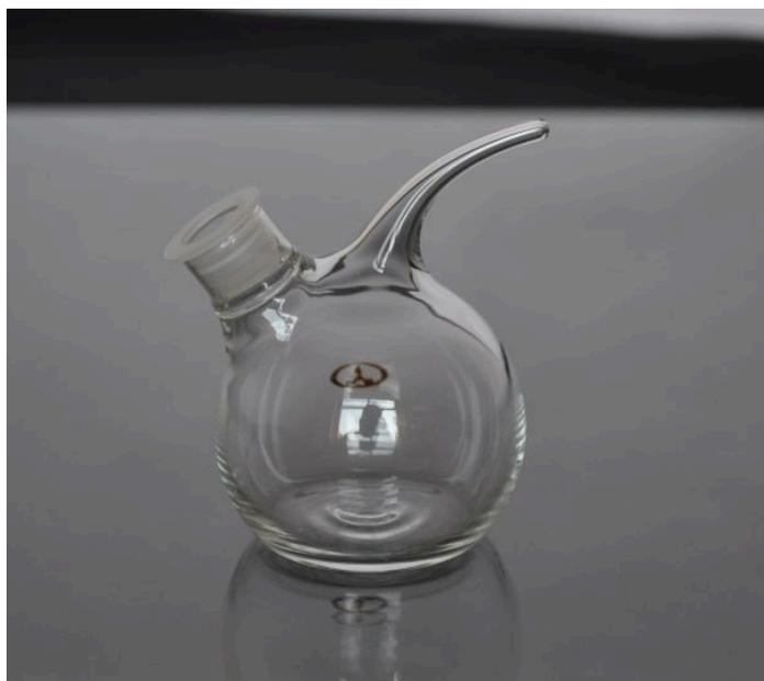
Лабораторная капельница – это разновидность посуды, ключевое предназначение которой – капельное дозирование индикаторов и прочих растворов.
