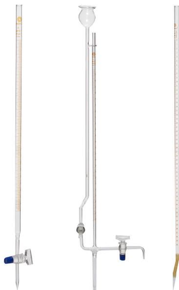
Применяется для отмеривания и переливания жидкостей в небольших объемах или для титрования. На корпус бюретки нанесена градуировка для отмеривания.
