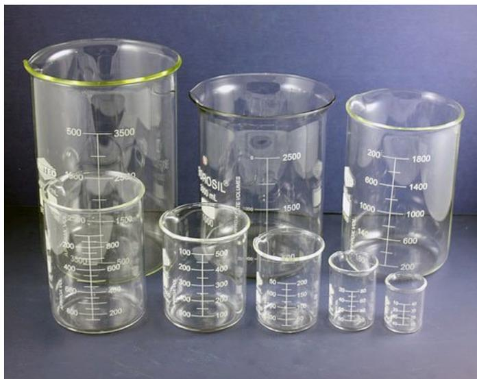
Стакан лабораторный Н (со шкалой) разработан для выполнения большинства химических процедур.
