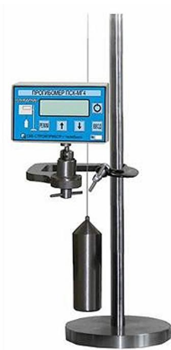
Прогибомер короткобазовый ПГ-1Ф предназначен для измерения обратимых прогибов при контрольных испытаниях методом статического нагружения колесом автомобиля при испытаниях дорожных одежд нагрузкой в соответствии с требованиями ОДН 218.1.052-2002 «Оценка прочности дорожных одежд»
