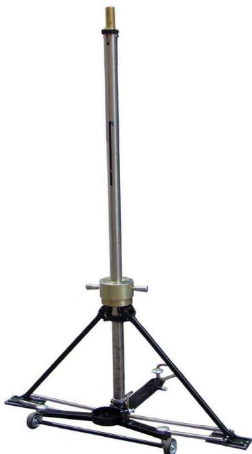
Предназначен для определения коэффициента сцепления колеса автомобиля с дорожным покрытием при
