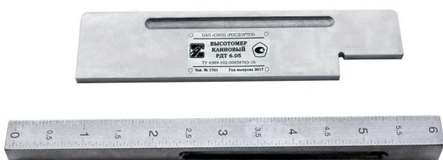
Определение высоты выступающей горизонтальной дорожной разметки над поверхностью, на которую она нанесена. Контроль высоты выступающей осуществляется клиновидным высотомером для горизонтальной дорожной разметки, выполненной термопластиком, холодными пластиками, штучными формами и полимерными лентами.
