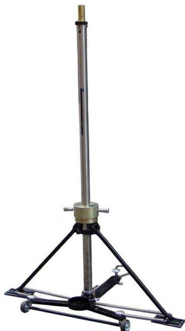
Комплект оснастки предназначен для определения параметров микрошероховатости дорожного покрытия методом «Песчаное пятно» по ВСН 38-90
