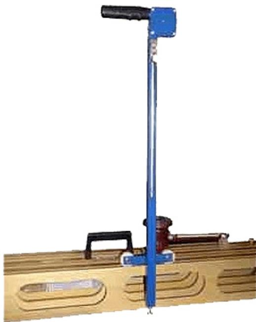
Приспособление к рейке универсальной «РДУ-Кондор» предназначено для определения величин поперечных деформаций(колейности) дорожных одежд.
