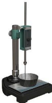
Конус предназначен для использования в комплекте с прибором для определения нормальной густоты, сроков схватывания и ложного схватывания цементного теста по ГОСТ 56588. Исполнение – нержавеющая сталь.
