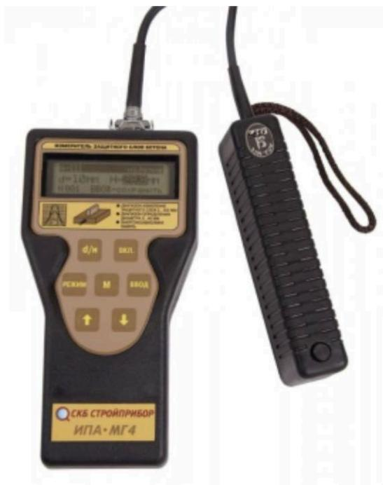
Приборы ИПА-МГ4 и ИПА-МГ4.01 предназначены для оперативного контроля толщины защитного слоя бетона и расположения стержневой арматуры в железобетонных изделиях и конструкциях магнитным методом по ГОСТ 22904.
