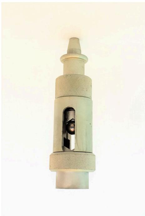
Эталонный стержень с известной прочностью и стержень, прочность которого необходимо определить, вставляются в Эталонмер (один под шариком, другой над шариком). Затем по наковальне Эталонмера наносят удар. По соотношению отпечатков, оставшихся на обоих стержнях после удара, определяют прочность (а следовательно и марку) тестируемого стержня.
