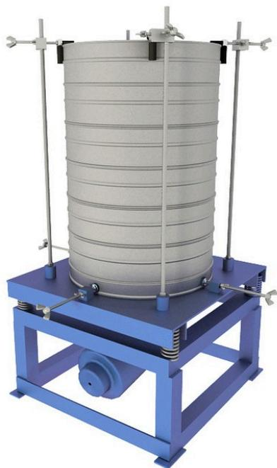
Для определения зернового состава щебня, песка и других строительных материалов по ГОСТ 8269.0-97, 8735-88.
