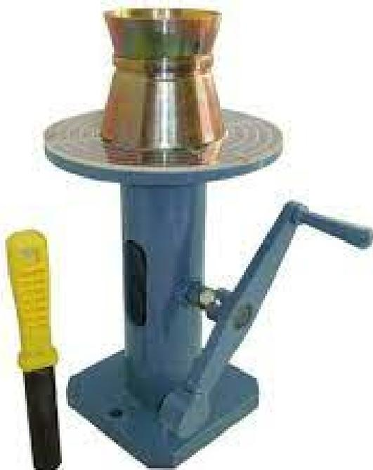
Столик ЛВС предназначен для определения консистенции цементного раствора по ГОСТ 310.4-81.
