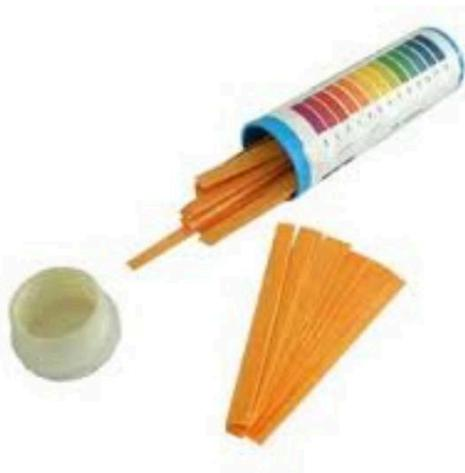
Индикаторная бумага для определения pH жидкостей представляет собой бумажные полоски с нанесенными на них индикаторами, изменяющими свой цвет в зависимости от pH среды. Они удобны и практичны для точного приготовления рабочих реагентов и контроля за определенным уровнем pH.
