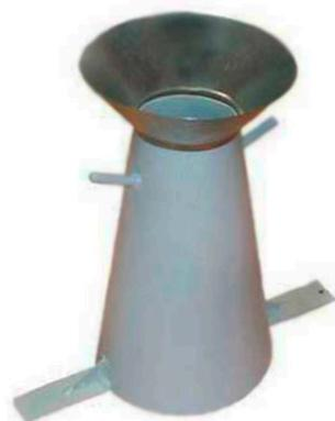
Используется в комплекте с конусом для определения подвижности бетонной смеси по ГОСТ 10181.
