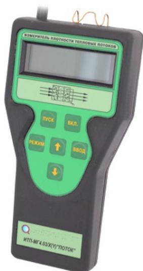
Приборы ИТП-МГ предназначены для измерения плотности тепловых потоков, проходящих через однослойные и многослойные ограждающие конструкции зданий и сооружений по ГОСТ 25380, через облицовку и теплоизоляцию энергообъектов при экспериментальном исследовании и в условиях эксплуатации.
