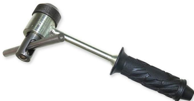
Молоток Кашкарова предназначен для определения прочности бетона в конструкциях методом ударного воздействия по размеру отпечатка согласно ГОСТ 22690-88.
