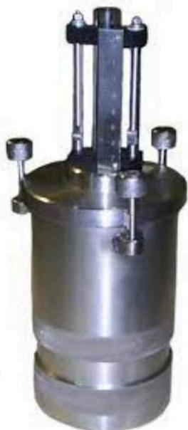
Контрактометр переносной для ускоренного определения активности цемента. Контрактометр позволит легко и просто определить активность цемента в лабораторных условиях.
