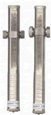
Твердомер ШТ-1 по ИСО 1518 и ИСО 6441 предназначен для быстрого определения твердости лакокрасочных, мастичных, пластиковых и других покрытий методом определения твердости по сопротивлению вдавливанию сферического наконечника диаметра 1 мм. ИСО 6441. Лаки и краски. Определение твердости покрытий по Кнупу по глубине отпечатка сферического наконечника с диаметром наконечника 1 мм.
