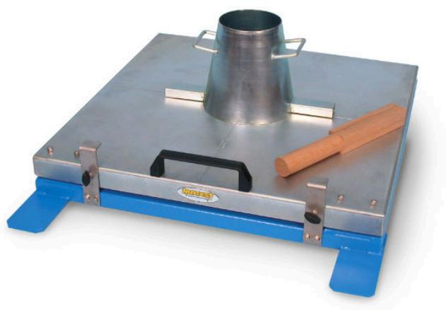
Стол С192 КИТ предназначен для определения расплыва бетонной смеси по ГОСТ 10181-2014. Стол С192 КИТ включает в себя стальной оцинкованный конус  $\varnothing 130/200 \times 200$  мм, деревянную трамбовку, стальной стол из двух частей, скрепленных двумя петлями, с верхней оцинкованной частью  $700 \times 700$  мм
