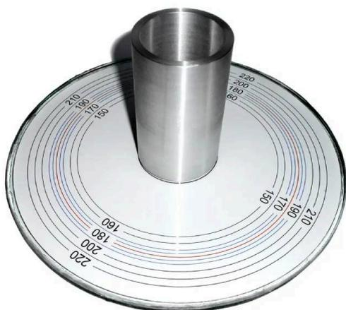
Вискозиметр Суттарда ВС служит для определения сроков схватывания гипсового теста по ГОСТ 23789-2018. Полированная рабочая поверхность вискозиметра повышет качество испытаний. Исполнение - нержавеющая сталь 12Х18Н10Т.
