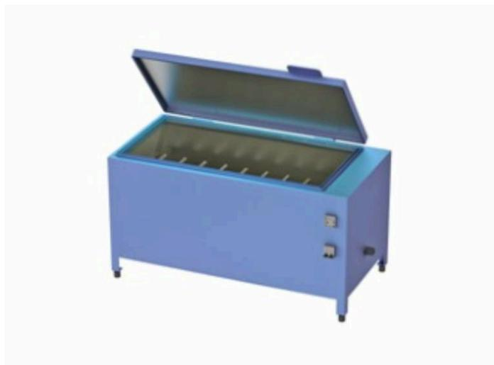
Камера универсальная пропарочная КПЦ-1 предназначена для испытания образцов цемента по ГОСТ 310.4.
