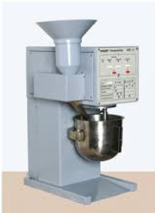
Смеситель лабораторный используется для приготовления цементного теста при определении нормальной густоты смеси, сроков схватывания и равномерности изменения объема испытуемого материала по ГОСТ 30744. Также смеситель применяют для приготовления цементных растворов, которые используют при изготовлении образцов балочек по ГОСТ 30744 и в соответствии с требованием европейского стандарта EN196
