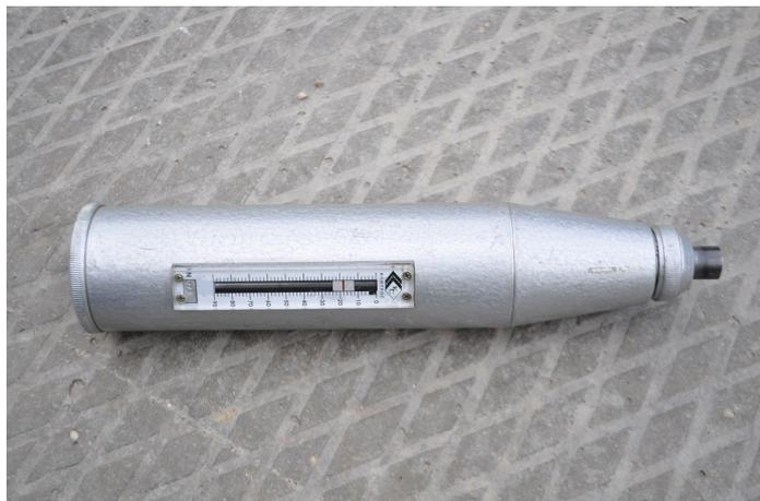
Склерометр предназначен для определения прочности бетона на сжатие в диапазоне от 5 до 40 МПа в бетонных и железобетонных конструкциях и изделиях методом упругого отскока по ГОСТ 22690.
