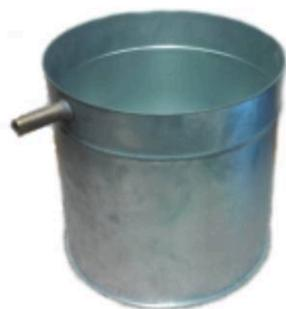
Сосуд с трубкой используется для определения объема бетонных образцов неправильной формы по ГОСТ 12730.1.
