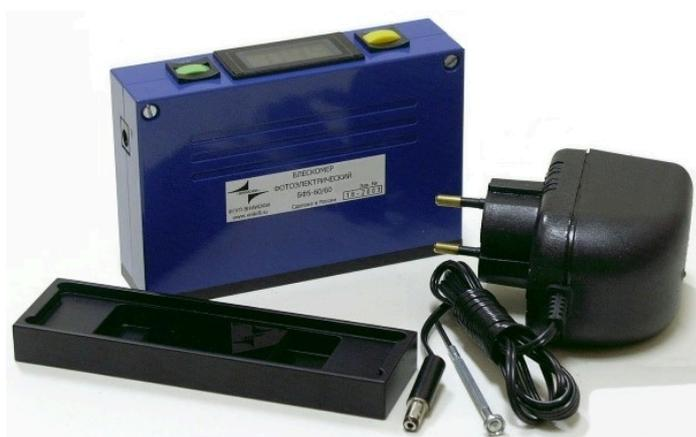
Блескомеры фотоэлектрические - это переносные, малогабаритные блескомеры применяются для измерения коэффициента блеска лакокрасочных покрытий фотоэлектрическим методом при углах подсвета - отражения пучка света – 20°, 60°, 45°. Используются для определения коэффициента блеска покрытий фотоэлектрическим методом по ГОСТ 896-69 и ИСО 2813.
