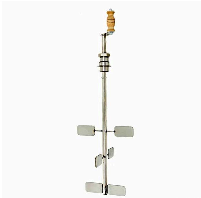
Ручная мешалка предназначена для определения сроков схватывания гипсового теста по ГОСТ 23789.
