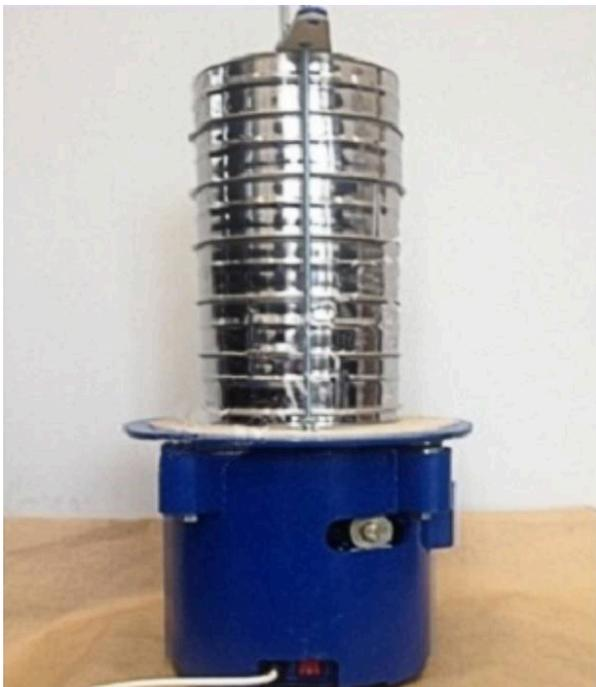
Рассев лабораторный РЛ-1 предназначен для разделения различных материалов при определении гранулометрического состава и подготовке проб. Принцип действия сесева РЛ-1 основан на сообщении возвратно-поступательных винтовых колебаний столику и закрепленных элементов. Рассев лабораторный применяется при сесеве материалов (песок, щебень, гравий, грунт, минеральный порошок, цемент, асфальтобетон и пр.)
