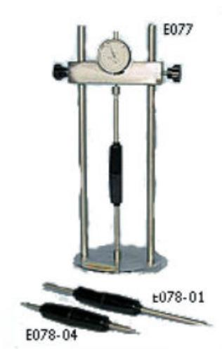
Используется для измерения линейных изменений размеров образца при проведении автоклавного теста на равномерность усадки.
