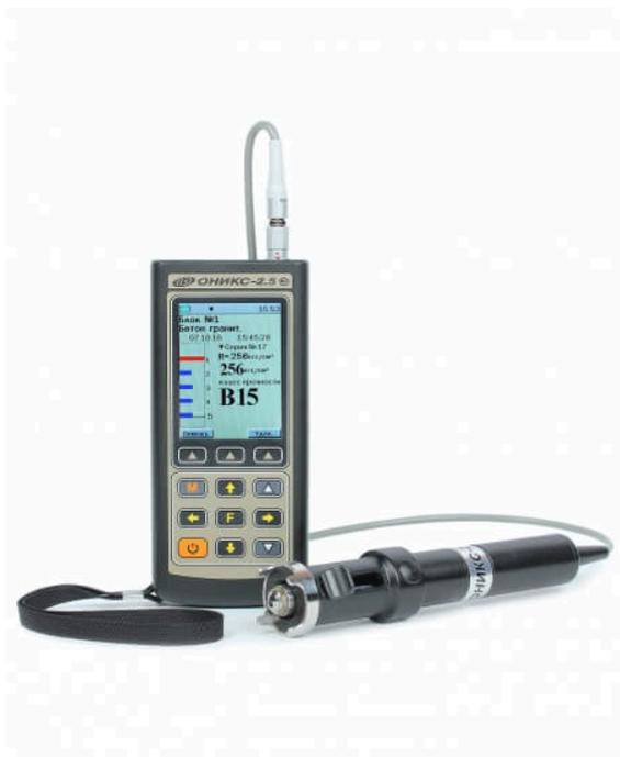
Электронные склерометры ОНИКС предназначены для оперативного контроля прочности и однородности бетона (ГОСТ 22690) при технологическом контроле, обследовании объектов, а также для контроля кирпича, легких бетонов и т.п.
