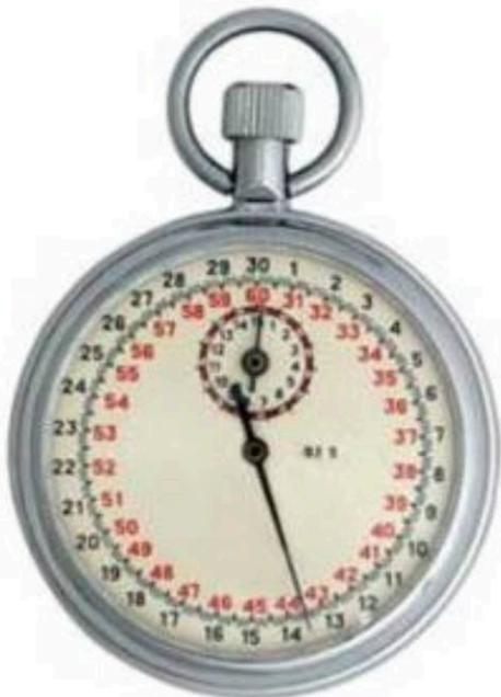
Однострелочный секундомер СОППр, прерывание часового механизма с помощью одной кнопки. Предназначен для измерения интервалов времени с ценой деления 0,1 сек, имеет 30-ти секундную шкалу с ценой деления 0,1 сек и 15-ти минутный счетчик с ценой деления 1 мин.
