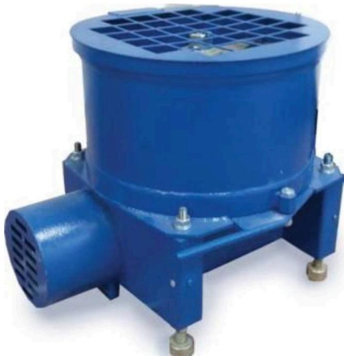
Бетоносмеситель лабораторный, настольный, принудительного действия (турбулентный) предназначен для приготовления растворов и бетонов в лабораториях для контроля качества строительных материалов. Благодаря высокой скорости перемешивания (в 4-5 раз большей, чем у классической барабанной мешалки) достигается высокое качество конечной смеси за короткое время.
