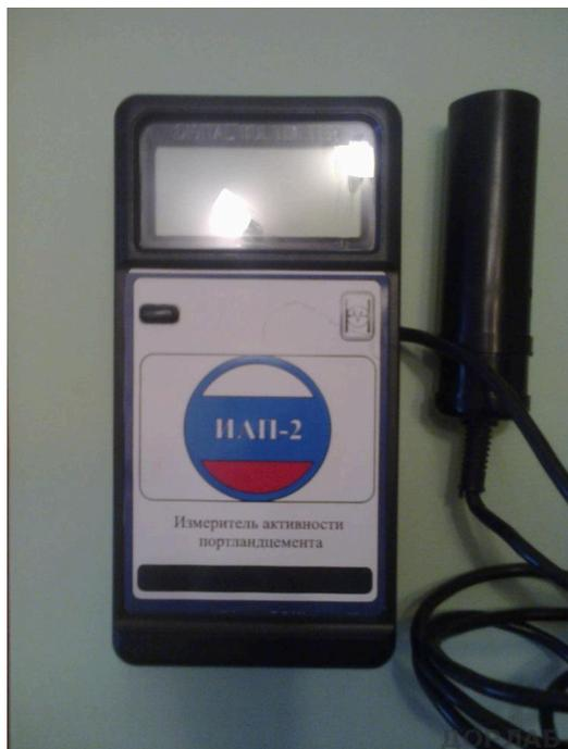
Прибор ИАП-2 (в дальнейшем - прибор) предназначен для определения активности портландцемента, портландцемента с минеральными добавками, шлакопортландцемента. Прибор применяется в заводских и научно-исследовательских лабораториях при проведении экспресс-исследований свойств минеральных вяжущих веществ. Прибор не внесен в Госреестр РФ.
