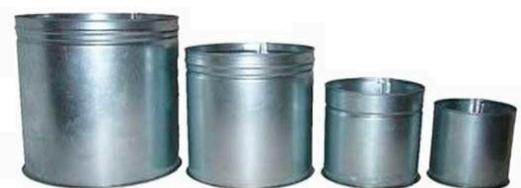
Мерные цилиндрические сосуды КП-601/4 предназначены для испытания щебня при определении насыпной плотности и пустотности по ГОСТ 8269.
