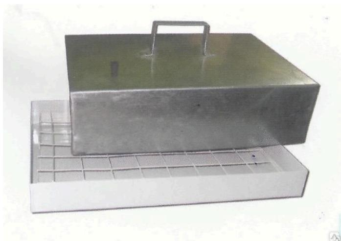
Ванна с гидрозатвором ВГЗ предназначена для хранения образцов во влажных условиях в соответствии с ГОСТ 10180.
