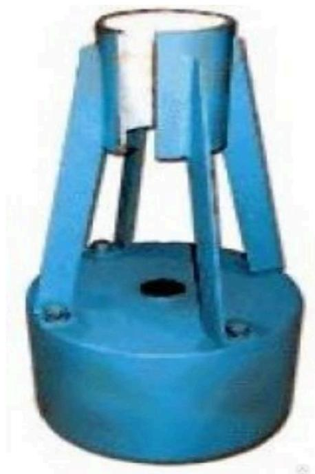
Наковальня состоит из массивного цилиндрического основания, в которое запрессован пуансон из закалённой стали, и направляющей гильзы, закреплённой на основании и обеспечивающей требуемое положение склерометра при ударе.
