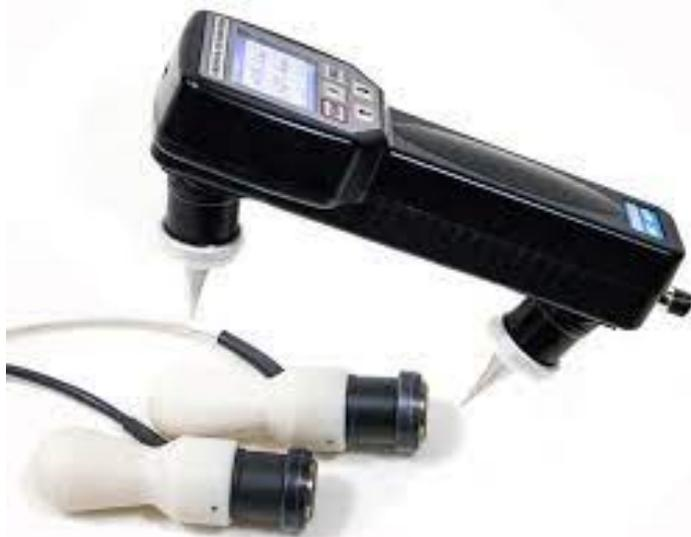
Приборы УКС-МГ4, УКС-МГ4С предназначены для контроля дефектов, определения прочности бетона в сборных и монолитных бетонных и железобетонных изделиях и конструкциях по ГОСТ 17624, определения прочности силикатного кирпича по ГОСТ 24332 и других твердых материалов на основе измерения времени распространения импульсных ультразвуковых колебаний (УЗК) на установленной базе прозвучивания.
