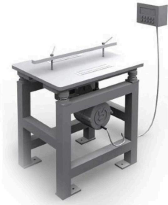
Грохот КП (на базе виброплощадки) предназначен для отсева песка, определения зернового состава щебня по ГОСТ 8269.0-97. Грохот соответствует исполнению «У» категории 3 по ГОСТ 15150-69, но для работы при температурах не ниже +5°C.
