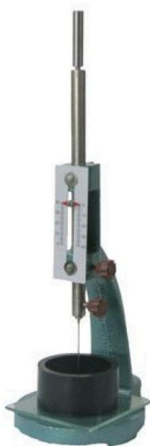
Прибор Вика ОГЦ предназначен для определения нормальной густоты и сроков схватывания цементного теста по ГОСТ 310.3-76.
