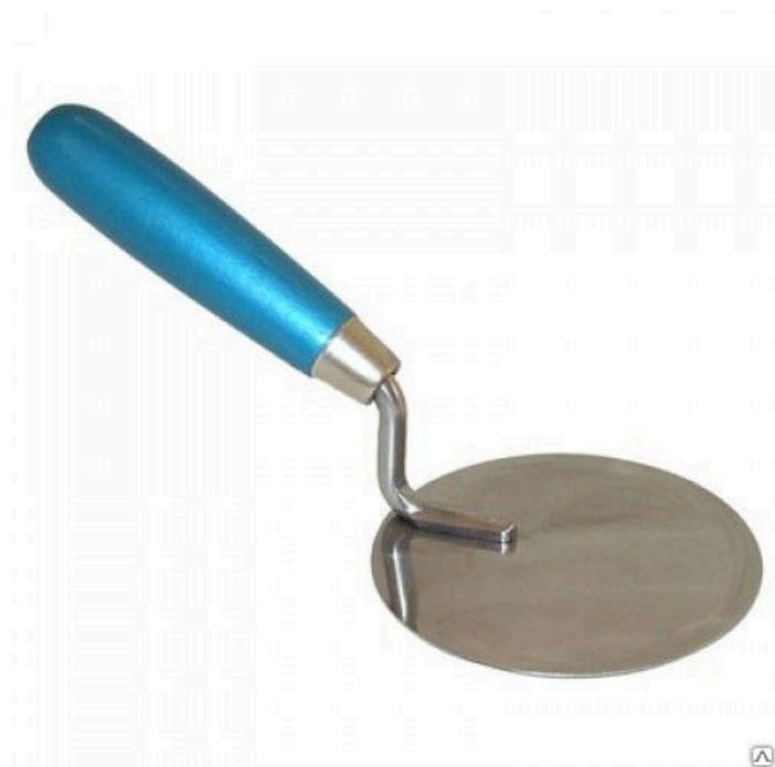
Лопатка ЛЗ служит для перемешивания цементного теста в лабораторных условиях по ГОСТ 310.3-76
