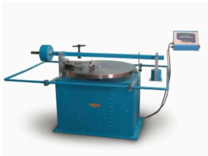
Применяется для определения уменьшения объема образца при испытаниях на истираемость таких материалов, как:
