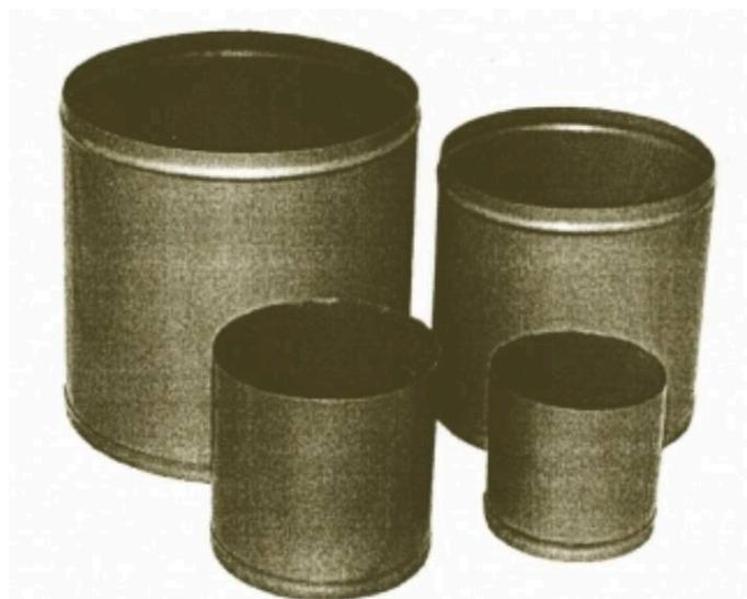
Мерные цилиндрические сосуды КП-601/4 предназначены для испытания щебня при определении насыпной плотности и пустотности по ГОСТ 8269.
