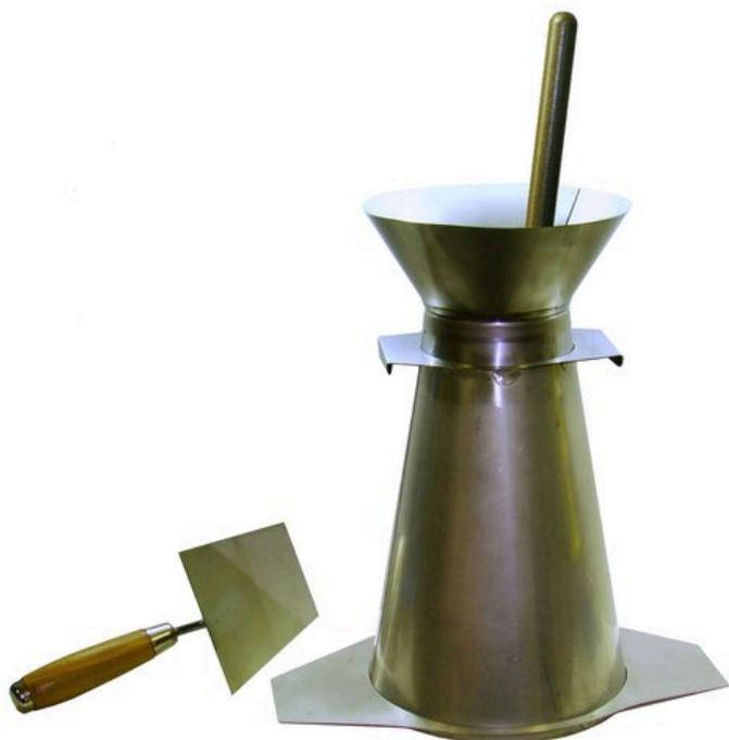
Конус КА предназначен для определения подвижности бетонной смеси на плотных и пористых заполнителях в соответствии с ГОСТ 10181-2000.
