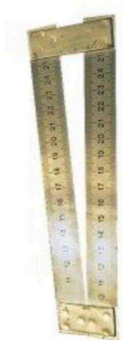
Замер диаметра отпечатка, остающегося на бетоне и стержне после удара молотком Кашкарова (ГОСТ 22690-88).
