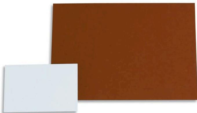
При измерении расстояний (до 40 м.) лазерным дальномером используйте белую поверхность пластины, при измерении расстояний более 40 м используйте красную поверхность пластины.
