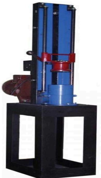
Копер ПМА-Ф (автоматический) предназначен для балластного слоя железнодорожного пути по ГОСТ 7392-2002. С помощью прибора по ГОСТ 8269.0-97 определяют по степени разрушения зерен, оцениваемой изменением зернового состава пробы, сопротивление щебня удару.
