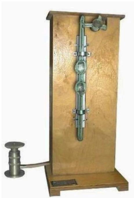
Предназначен для измерения удельной поверхности цементов. Может применяться для измерения удельной поверхности ряда других порошкообразных материалов (гипса, угольной пыли).
