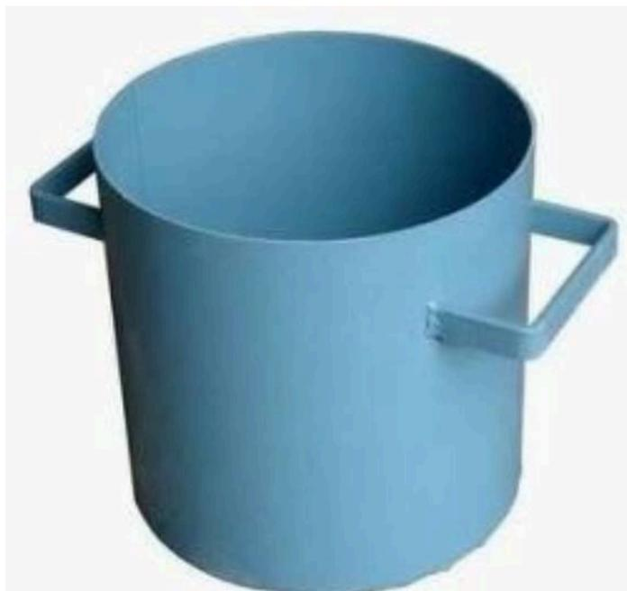
Сосуд мерный цилиндрический 5л СМ (с усиленным дном и ручками) предназначен для испытания щебня при определении насыпной плотности и пустотности по ГОСТ 33047-2014. Цилиндрический мерный сосуд представляет собой емкость, отношение внутреннего диаметра которого к внутренней глубине составляем от 0,5 до 0,8 мм.
