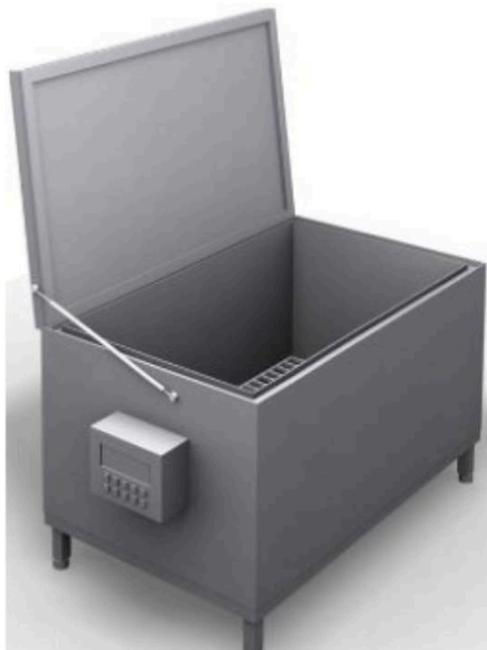
Ванна ВЦ-1 предназначена для насыщения водой и оттаивания щебня с помощью проточной воды заданной температуры по ГОСТ 8269.0.
