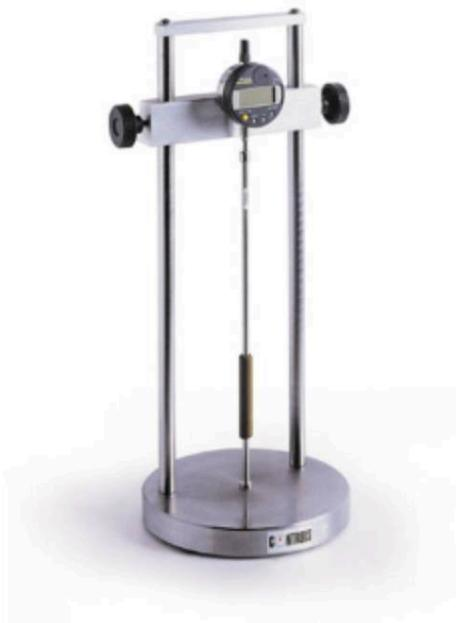
Данное устройство служит для определения изменения длины цементных призм в ускоренных испытаниях на равномерность изменения объема и линейной усадки цементного раствора. Оно также используется для измерения изменения длины образцов бетона и цемента размером 40x40x160 мм, а также других размеров.
