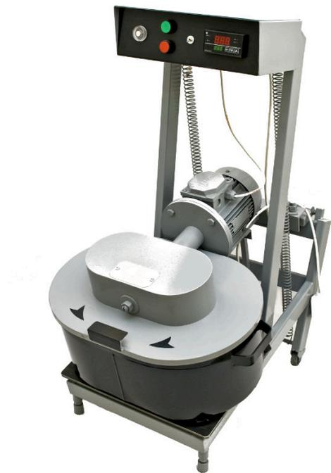
МЛ-20 -для приготовления асфальтобетонов (песчаного, мелкозернистого, крупнозернистого) в дорожных лабораториях.
