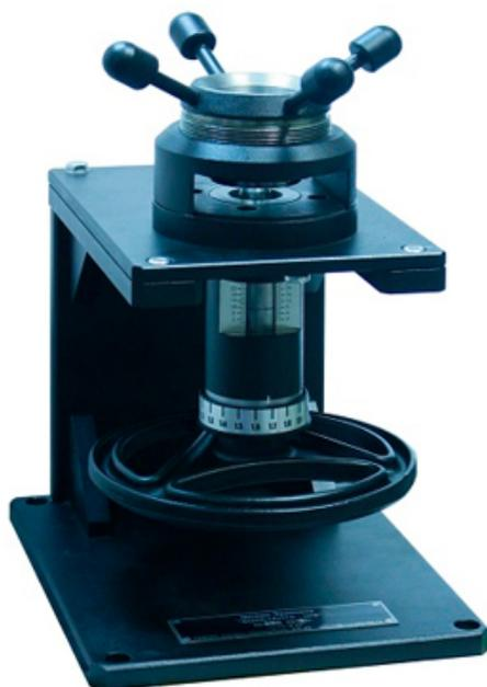
Измерение эластичности, прочности и стойкости ЛКП к растяжению, растрескиванию, отслаиванию от металлической поверхности методом вдавливания на определенную глубину пуансона со сферическим наконечником.
