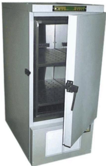
Камера нормального твердения КНТ предназначена для хранения бетонных образцов при температуре  $20\pm 2^{\circ}\text{C}$ , относительной влажности  $95\pm 5\%$  по ГОСТ 10180-90.
