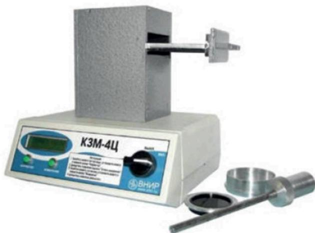
Определение содержания пылевидных и глинистых частиц в щебне, гравии и песке по ГОСТ 8269/0-97 и ГОСТ 8735-88 взамен методов отмучивания и мокрого просеивания. Прибор является фотоэлектрическим концентратомером взвешенных частиц в суспензиях.
