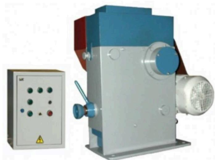
Дробилка состоит из корпуса, к которому крепится загрузочная воронка. Дробление происходит в пространстве между бронями, покрывающими неподвижную и подвижную дробящие щеки и имеющими гребенчатый профиль в поперечном сечении. Боковые стенки корпуса предохраняются от износа футеровками.
