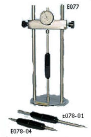
Используется для измерения линейных изменений размеров образца при проведении автоклавного теста на равномерность усадки.
