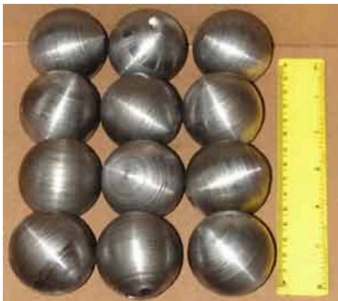
12 стальных шаров предназначены для определения истираемости щебня (гравия) по ГОСТ-8269-97, 33049-14 в полочном барабане КП-123Р
