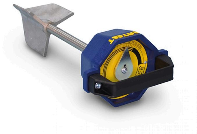
Используется для быстрого и легкого измерения пластичности смесей, также для обнаружения излишков воды. Возможно измерение пластичности в нескольких точках прямо при укладке смеси. Измеряет усилие сдвига, прикладываемое к крыльчатке во время испытания. Полученные значения можно легко сопоставить с результатами испытаний с конусом Абрамса.
