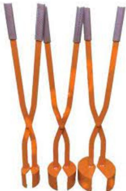
Шипцы к буровой установке, предназначены для извлечения выбуренных кернов из дорожного покрытия.
