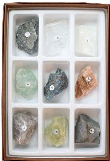
Твёрдость минерала - это сопротивление, оказываемое кристаллом царапающему, сверлящему, шлифующему или давящему предмету. На преодоление этого сопротивления должна быть затрачена определенная работа, которая может быть принята за меру твёрдости. В минералогии твёрдость минерала определяется по 10-бальной шкале, предложенной австрийским химиком и минералогом Фридрихом Моосом в 1811г.
