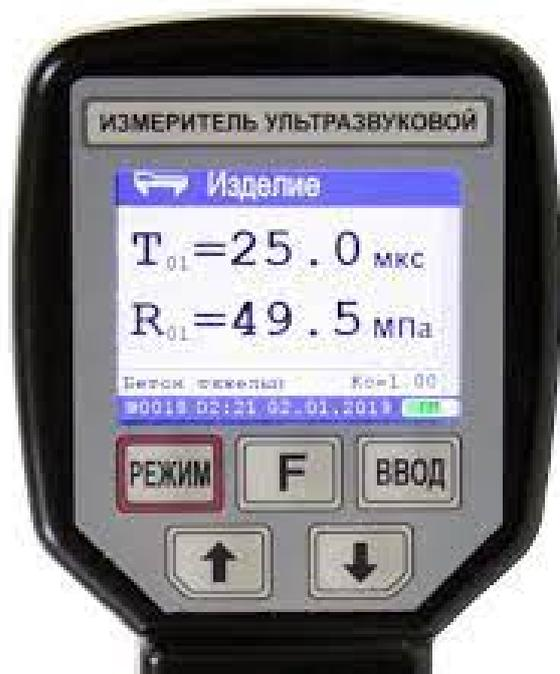
Приборы УКС-МГ4, УКС-МГ4С предназначены для контроля дефектов, определения прочности бетона в сборных и монолитных бетонных и железобетонных изделиях и конструкциях по ГОСТ 17624, определения прочности силикатного кирпича по ГОСТ 24332 и других твердых материалов на основе измерения времени распространения импульсных ультразвуковых колебаний (УЗК) на установленной базе прозвучивания.
