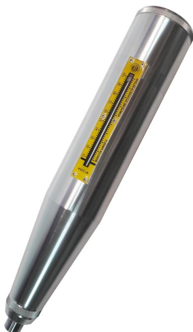
Молоток Шмидта 75А предназначен для измерения прочности швов со строительным раствором в кирпичной кладке. Он является механическим устройством для быстрого неразрушающего контроля качества материалов. Измерение прочности на сжатие происходит без разрушения материалов. Прочность определяется по предварительно установленной градуировочной зависимости между прочностью образцов и значением отскока от поверхности изделия прижатого к ней ударника (косвенной характеристикой прочности).
