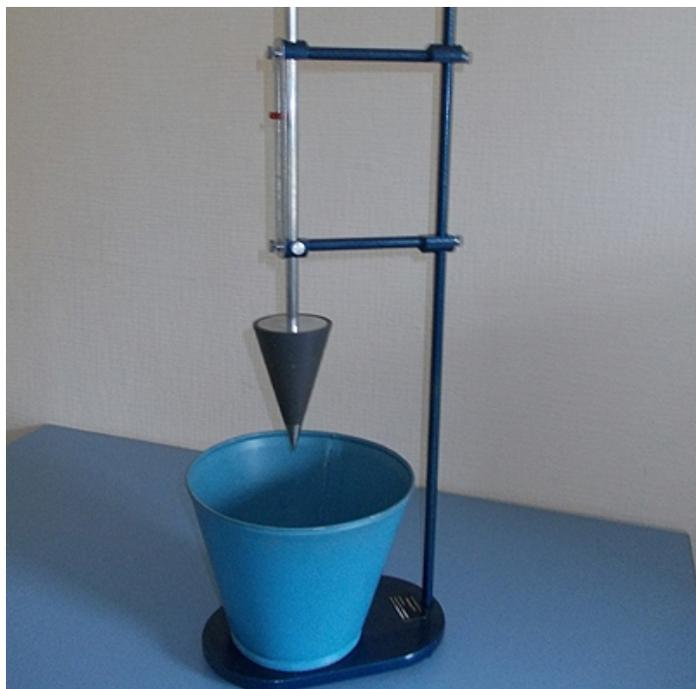
Прибор ПГР-1Ц с цифровым измерителем перемещения предназначен для определения густоты раствора по ГОСТ 5802-86. Прибор ПГР-1Ц состоит из: ёмкости для испытуемого раствора и конуса (нерж. сталь), который закреплен (пайкой) на стальной линейке. Конус перемещается во втулке подвижного кронштейна, который передвигается по стойке, закрепленной на опорной плите. Для удержания конуса на требуемой высоте предусмотрен винт с насечкой. ПГР-1Ц оснащен цифровым измерителем перемещения.
