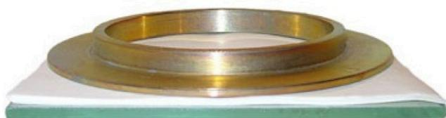
Водоудерживающая способность определяется путём испытания слоя растворной смеси, толщиной 12 мм, уложенного на промокательную бумагу.
