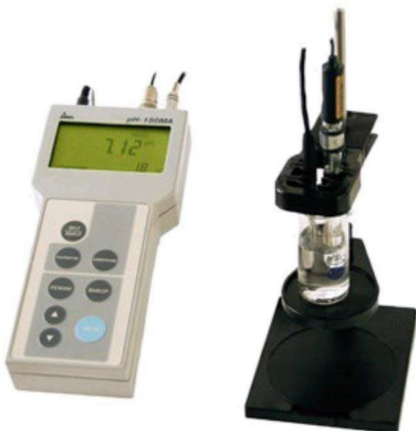
Прибор предназначен для измерения активности ионов водорода (рН), ЭДС электродных систем, окислительно-восстановительного потенциала (Еh) и температуры водных сред. рН-метр может применяться в лабораториях предприятий и научно-исследовательских учреждений различных отраслей промышленности, а также для оперативных измерений на предприятиях пищевой промышленности (хлебопекарная, мясоперерабатывающая и др.) и в области охраны окружающей природной среды.
