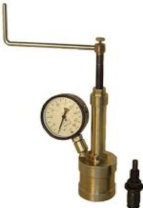
Для определения прочности бетона в изделиях и конструкциях методом отрыва со скалыванием по ГОСТ 22690-88
