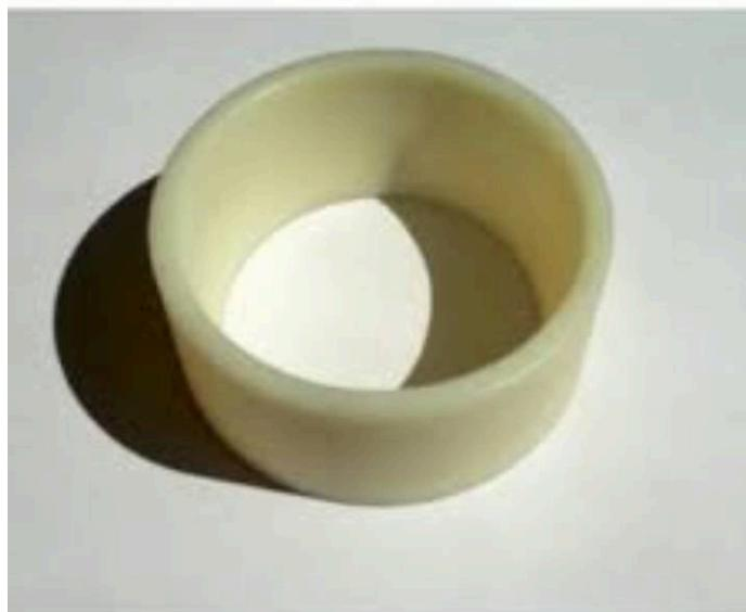
Кольцо предназначено для определения нормальной густоты и сроков схватывания цементного раствора по ГОСТ 30744.
