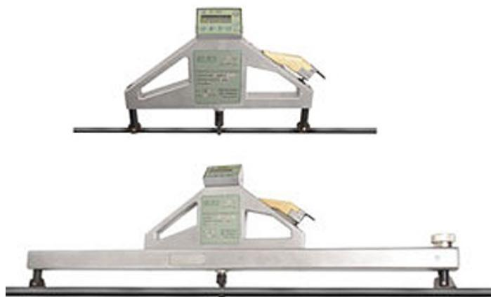
Приборы ДО-40МГ4 и ДО-60МГ4 предназначены для оперативного производственного контроля силы натяжения проволочной и канатной арматуры железобетонных конструкций методом поперечной оттяжки по ГОСТ 22362, а также для контроля усилий в тросовых и канатных оттяжках.
