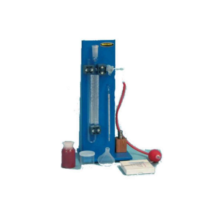
Аппарат предназначен для определения тонкости помола цемента, которая определяется как общая площадь поверхности в кв. сантиметрах на 1 грамм цемента. Предназначен для эффективного смешивания цементного теста и строительных растворов.
