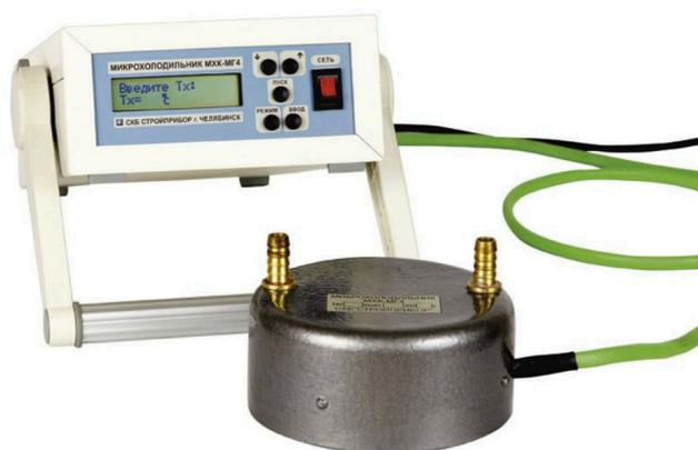
Микрохолодильник контактный МХК-МГ4 предназначен для быстрого охлаждения участков поверхности образцов материалов до заданной температуры, в частности, при испытании стеклопакетов по ГОСТ 24866 с целью определения точки росы. Микрохолодильник предназначен для работы в закрытых помещениях испытательных лабораторий при температуре +5...+50°C.
