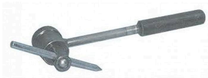
Стержни используется в качестве приспособления к молотку Кашкарова при определении прочности бетона. Молоток Кашкарова предназначен для определения прочности бетона в конструкциях методом ударного воздействия по размеру отпечатка согласно ГОСТ 22690-88.
