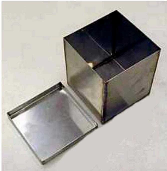
Емкость используется в морозильных камерах для испытаний бетонных образцов на морозостойкость
