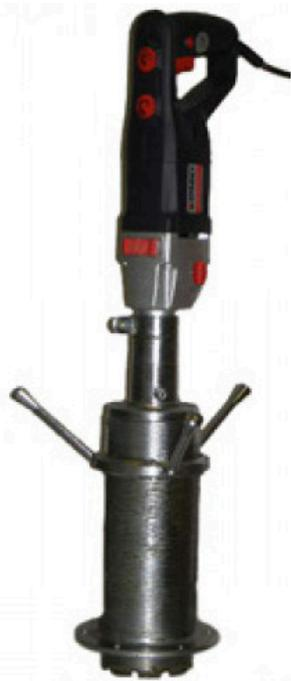
По цилиндрическому корпусу, с наружной резьбой, вращается гайка с тремя рукоятками. В верхнюю часть корпуса, ввинчивается узел подшипников, в котором вращается шпиндель, который передает вращающий момент от электродрели сверлу.
