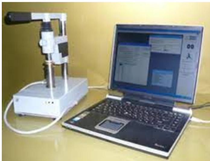
Прибор ПСХ предназначен для лабораторных исследований и контроля технологических процессов диспергирования твердых материалов по величине их удельной поверхности и среднему размеру частиц. Все измерения и расчеты автоматизированы, что исключает фактор субъективной ошибки. Удельную поверхность ( $S$ , см<sup>2</sup>/г) и среднемассовый размер частиц ( $d$ , мкм) исследуемых дисперсных материалов прибор рассчитывает, визуализирует на дисплее NOTEBOOK, хранит в памяти и печатает в виде таблиц.
