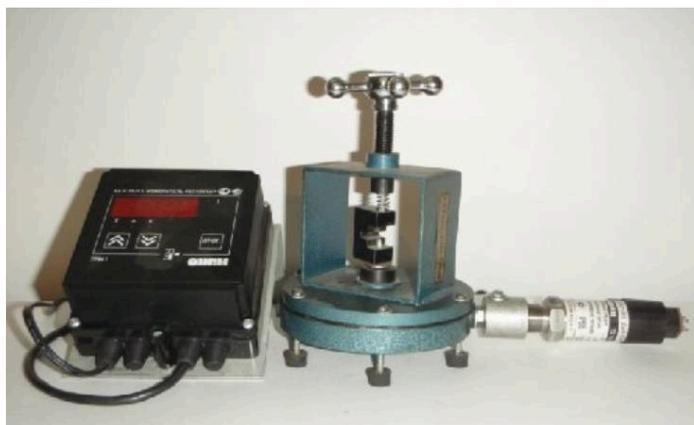
Усилие, создаваемое верхним зубом при вращении рукоятки передается на щебень и на нижний зуб, опирающийся на шток рабочей камеры.
