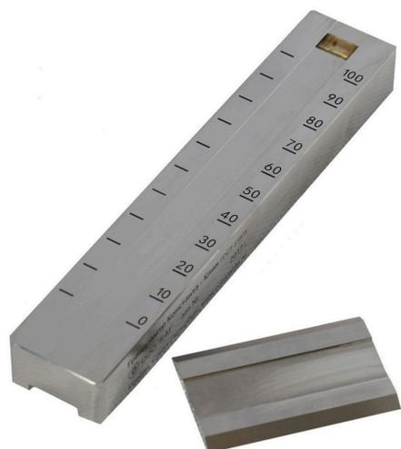
Прибор для определения степени перетира по ГОСТ 6589 (150 мкм, 100 мкм, 50 мкм, 25 мкм, 15 мкм).
