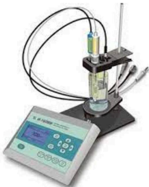
Лабораторный иономер И-160МИ предназначен для прямого и косвенного потенциометрического измерения активности ионов водорода (рН), активности и концентрации других одновалентных и двухвалентных анионов и катионов (рХ), окислительно-восстановительных потенциалов (Еh) и температуры в водных растворах с представлением результатов в цифровой форме и в виде аналогового сигнала напряжения постоянного тока.
