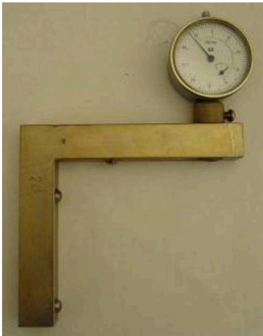
Прибор для измерения отклонения от перпендикулярности НПР-1 предназначен для определения отклонений от прямого угла опорных граней образцов бетона по ГОСТ 10180.
