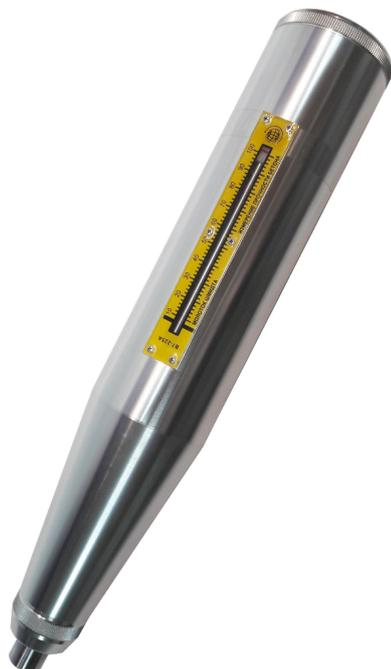
Молоток Шмидта 225А предназначен для измерения прочности швов со строительным раствором в кирпичной кладке. Он является механическим устройством для быстрого неразрушающего контроля качества материалов. Измерение прочности на сжатие происходит без разрушения материалов. Прочность определяется по предварительно установленной градуировочной зависимости между прочностью образцов и значением отскока от поверхности изделия прижатого к ней ударника (косвенной характеристикой прочности).
