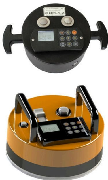
ВИП- моноблочный однокамерный прибор с встроенными: электроникой, электронасосом и литиевым силовым аккумулятором для ускоренного определние проницаемости бетона , раствора, и др. материалов в конструкциях, изделиях, образцах по ГОСТ 12730.5-84
