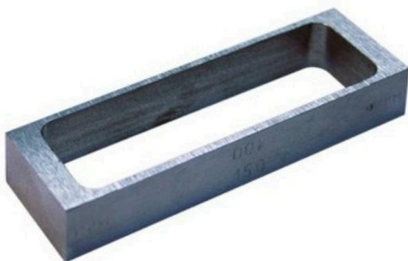
Нанесение слоев лакокрасочных материалов фиксированной толщины на стандартные пластины для последующего проведения комплексных испытаний.
