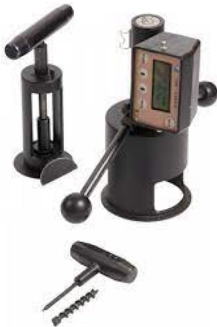
Приборы ПОС-100МГ4.У2 предназначены для неразрушающего контроля прочности бетона методом отрыва со скалыванием и скалывания ребра по ГОСТ 22690.
