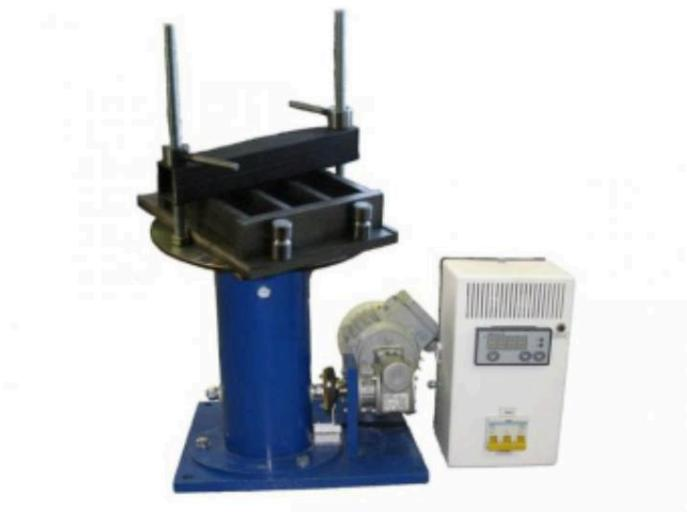
Столик ЛВС-А предназначен для определения консистенции цементного раствора по ГОСТ 310.4-81.
