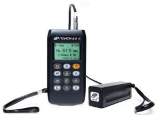
Прибор ПОИСК предназначен для измерения толщины защитного слоя бетона при оперативном контроле качества армирования железобетонных изделий и конструкций магнитным методом по ГОСТ 22904 на предприятиях и стройках, при обследовании зданий и сооружений. Прибор может также использоваться для определения участков поверхности конструкций свободных от залегающей арматуры при измерении прочности косвенными методами: ультразвуковым, ударно-импульсным, отрывом со скалыванием и сколом ребра.
