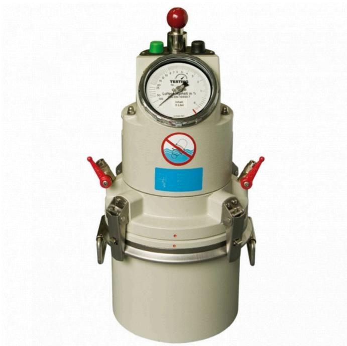
Объемомер ПП предназначен для определения объема вовлеченного воздуха в бетонную смесь по ГОСТ 10181.3-81.
