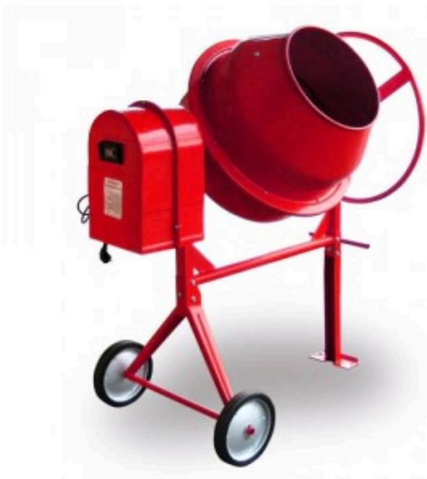
Бетоносмесители циклические гравитационные с ручным приводом опрокидывания предназначены для приготовления подвижных бетонных смесей с крупностью заполнителя до 40 мм и строительных растворов. Бетоносмесители могут быть также использованы для приготовления кормовых смесей, перемешивания удобрения, посевных и других сыпучих материалов.
