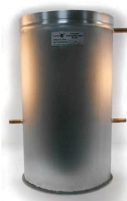
Сосуд для отмучивания щебня КП-305 предназначен для определения содержания пылевидных и глинистых частиц в щебне согласно ГОСТ 8269.0-97
