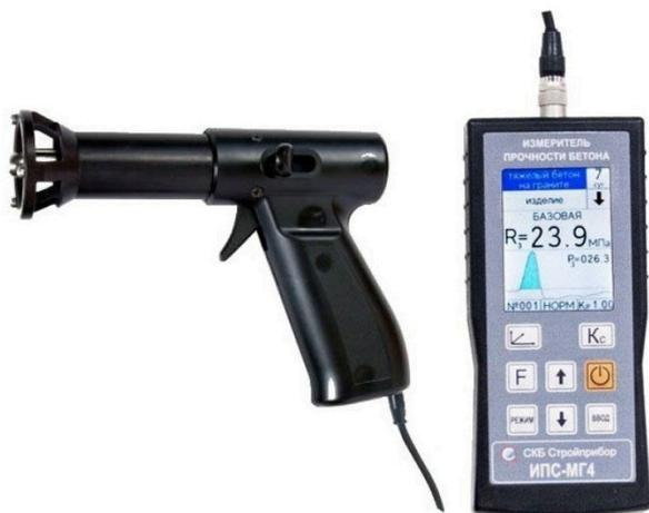
Измерители прочности бетона ИПС-МГ4.01, ИПС-МГ4.03, ИПС-МГ4.04 предназначены для определения прочности бетона методом ударного импульса по ГОСТ 22690, на основе предварительно установленной зависимости между прочностью бетона, определенной при испытании образцов в прессе и измеренным ускорением, возникающим при взаимодействии индентора измерителя с бетонным образцом, при постоянной энергии удара ( $E=0,12$  Дж).
