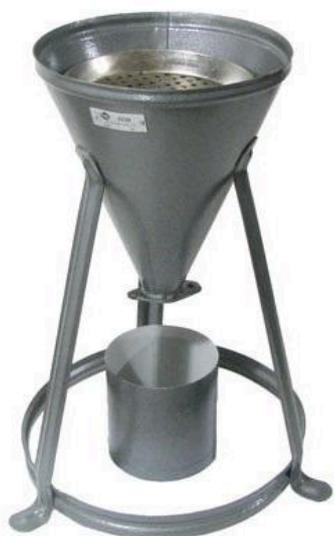
Воронка ЛОВ предназначена как вспомогательное приспособление для определения насыпного веса песка по ГОСТ 8735-88.
