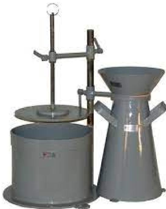
Установка типа Вебепредназначена для определения жесткости бетонной смеси в соответствии с ГОСТ 10181-2000
