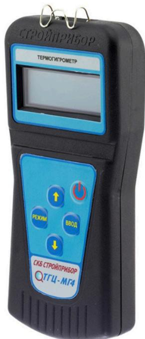
Термогигрометры цифровые предназначены для измерения относительной влажности и температуры в неагрессивных газовых средах производственных и жилых помещений, в сушильных и климатических камерах, вентиляционных системах
