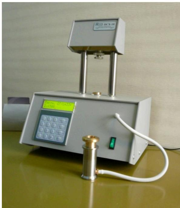
В приборе ПСХ наряду с измерениями удельной поверхности и среднего размера частиц порошков встроена дополнительная функция измерений коэффициента газопроницаемости образцов с открытой пористостью, вырезанных в виде цилиндра диаметром 50 мм и высотой 50 мм (по ГОСТу) или по ТУ - диаметром 36 мм и высотой 40 мм.
