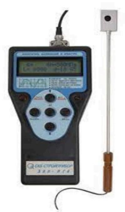
Измеритель напряжений ЭИН-МГ4 предназначен для оперативного производственного контроля предварительных напряжений в стержневой, проволочной и канатной арматуре железобетонных конструкций частотным методом по ГОСТ 22362.
