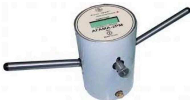
Устройство экспрессной оценки водонепроницаемости бетона, раствора в образцах и изделиях по воздухопроницаемости по ГОСТ 12730.5, прил. 4
