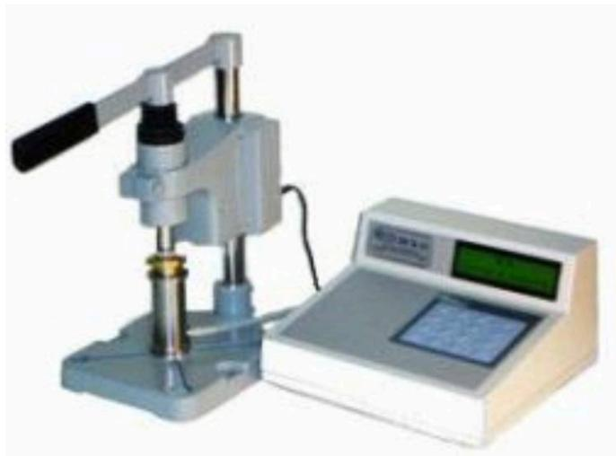
Прибор ПСХ-11 – это прибор для измерения удельной поверхности и среднего размера частиц порошков. ПСХ-11 - автономный высокоточный современный прибор. Все измерения и расчеты автоматизированы, что практически исключает фактор субъективной ошибки. Результаты измерений высвечиваются на дисплее.
