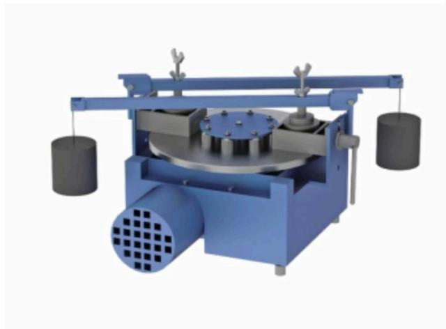
Лабораторный круг истирания ЛКИ предназначен для определения истираемости бетона в лабораторных условиях по ГОСТ 13087, ГОСТ 6787, керамических плиток по ГОСТ27180.
