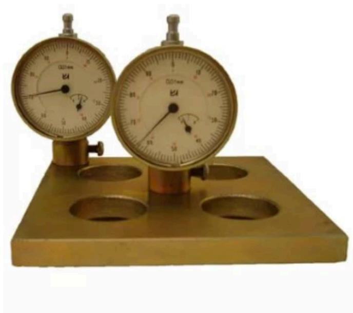
Прибор для измерения отклонений от плоскостности НПЛ-1 предназначен для определения отклонений опорных граней образцов бетона от плоскости по ГОСТ 10180.
