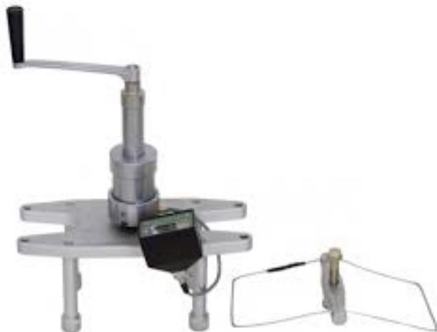
Приборы ПСО-20МГ4К, ПСО-30МГ4К, ПСО-50МГ4К предназначены для испытания прочности сцепления кирпича, природных и искусственных камней в кладке стен зданий методом нормального отрыва по ГОСТ 24992-81.
