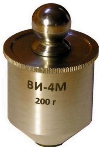
Прибор ВИ-4М предназначен для определения времени и степени высыхания всех лакокрасочных материалов методом отпечатка краски на копировальной бумаге или отпечатка и прилипаемости ватного тампона.
