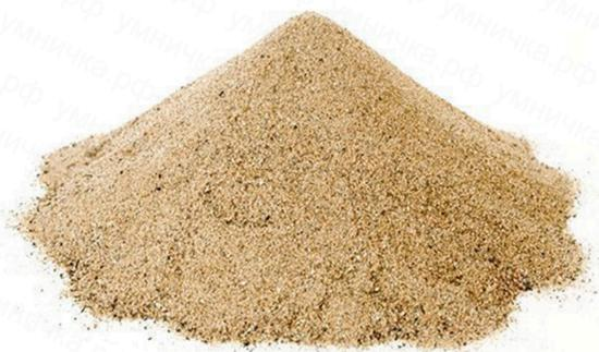
Стандартный (эталонный или нормальный) песок монофракционный Вольский предназначен для испытаний цемента.
