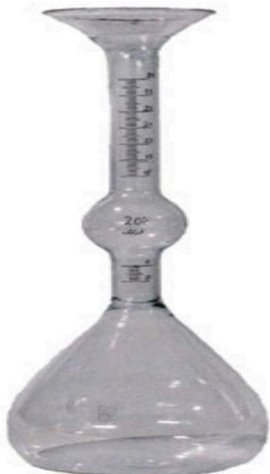
Определение плотности цемента по ГОСТ 310.2-76 и ГОСТ 30744-01; определение истинной плотности песка и горной породы, зерен щебня (гравия) по ГОСТ 8735-75 и ГОСТ 8269.0-97.
