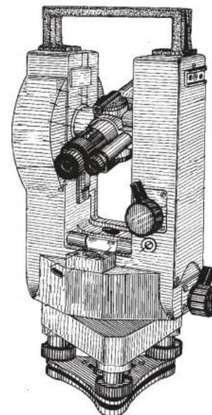
Рисунок 2 - Общий вид теодолита
