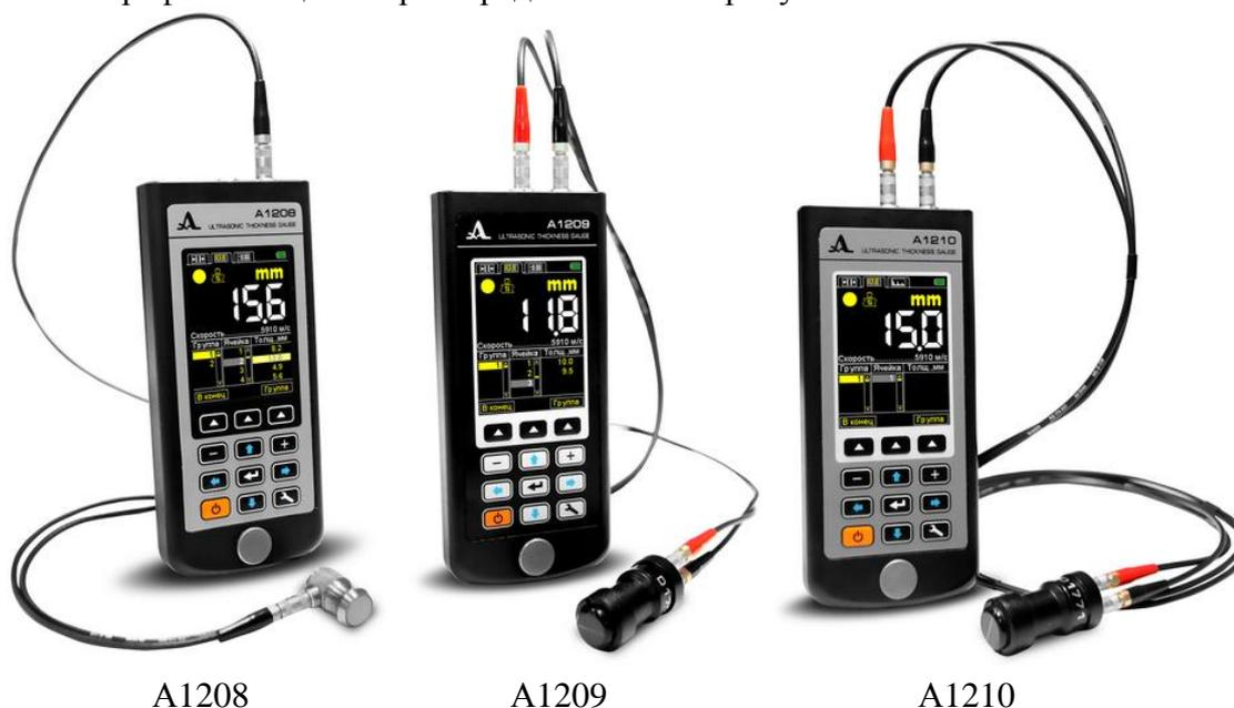
Рисунок 1 – Толщиномеры ультразвуковые А1208, А1209, А1210
