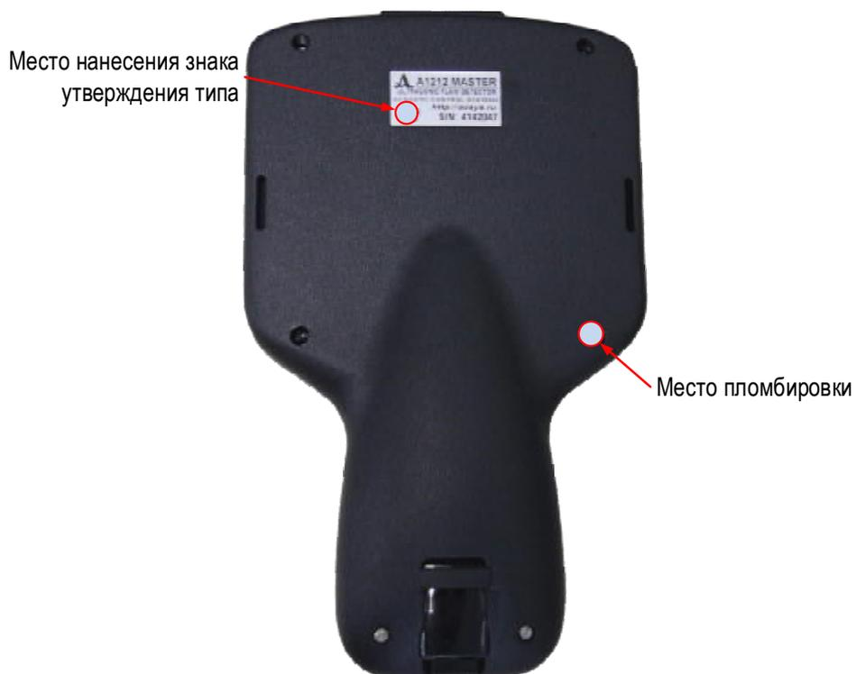
Рисунок 3 – Место пломбировки корпуса дефектоскопа А1212 MASTER и место знака утверждения типа
