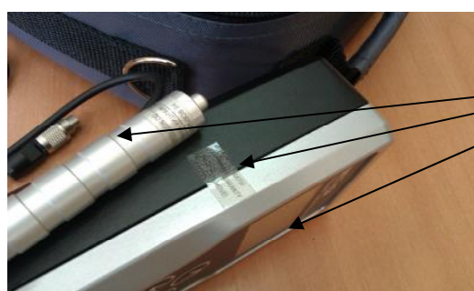
Рисунок 4 - Схема пломбировки твердомера.
